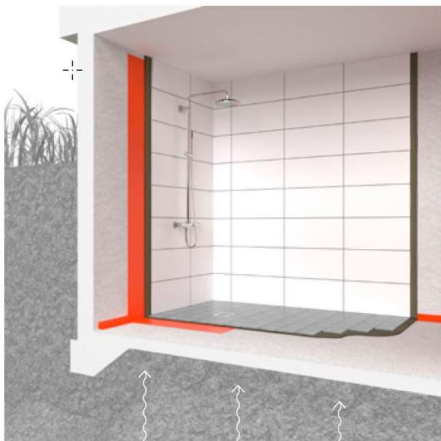
FIGUR 2. Källare med tillskjutande markfukt
