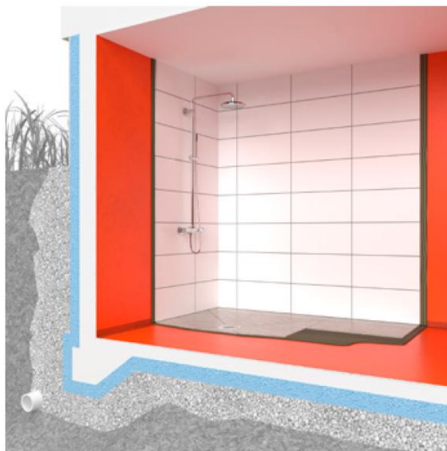
FIGUR 3. Källare utan tillskjutande markfukt
